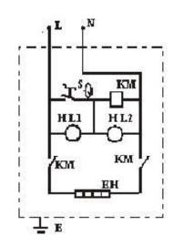
S—TEMPERATURE CONTROLLER HL1—POWER INDICATOR (GN) E—GROUND PROTECTION S1—TEMPERATURE LIMITER
