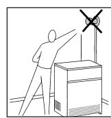
9 Der Wasserhahn sollte sich ebenso an einem leicht erreichbaren Platz neben der Maschine befinden.
