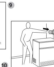
La vanne d'arrivée d'eau doit être facilement accessible et à proximité de l'appareil.
