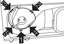
4. Hold the fan and unscrew the nut.
