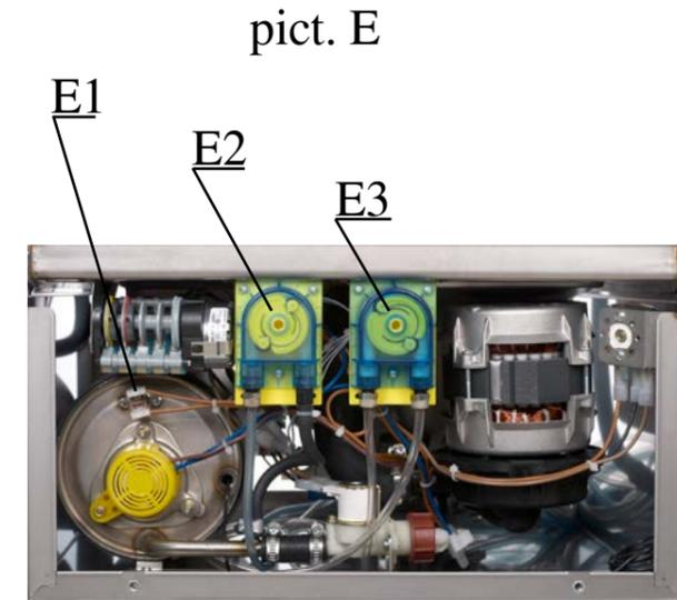
E1= termostato di sicurezza - safety thermostat
