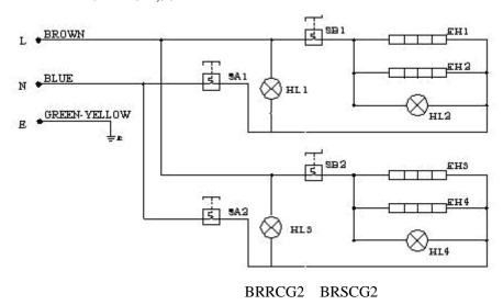
HL1, HL3----POWER INDICAOTR SA, SA1, SA2----TEMPERAUTRE CONTROLLER SB, SB1, SB2----TEMPERAUTRE CONTROLLER HL2, HL4----HEATING INDICATOR E----GROUND CONNECTION EH1, EH2, EH3, EH4----HEATING WIRE
