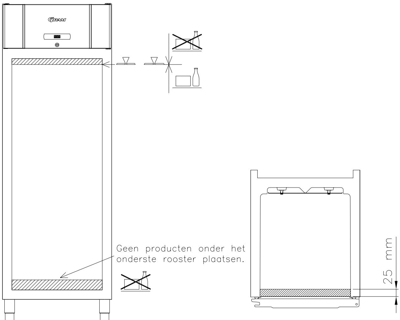
Dek alle levensmiddelen die niet bij voorbaat verpakt zijn en die in de kast moeten worden bewaard, goed af om onnodige corrosie van de delen in de kast zelf te vermijden, hieronder de verdamper.
