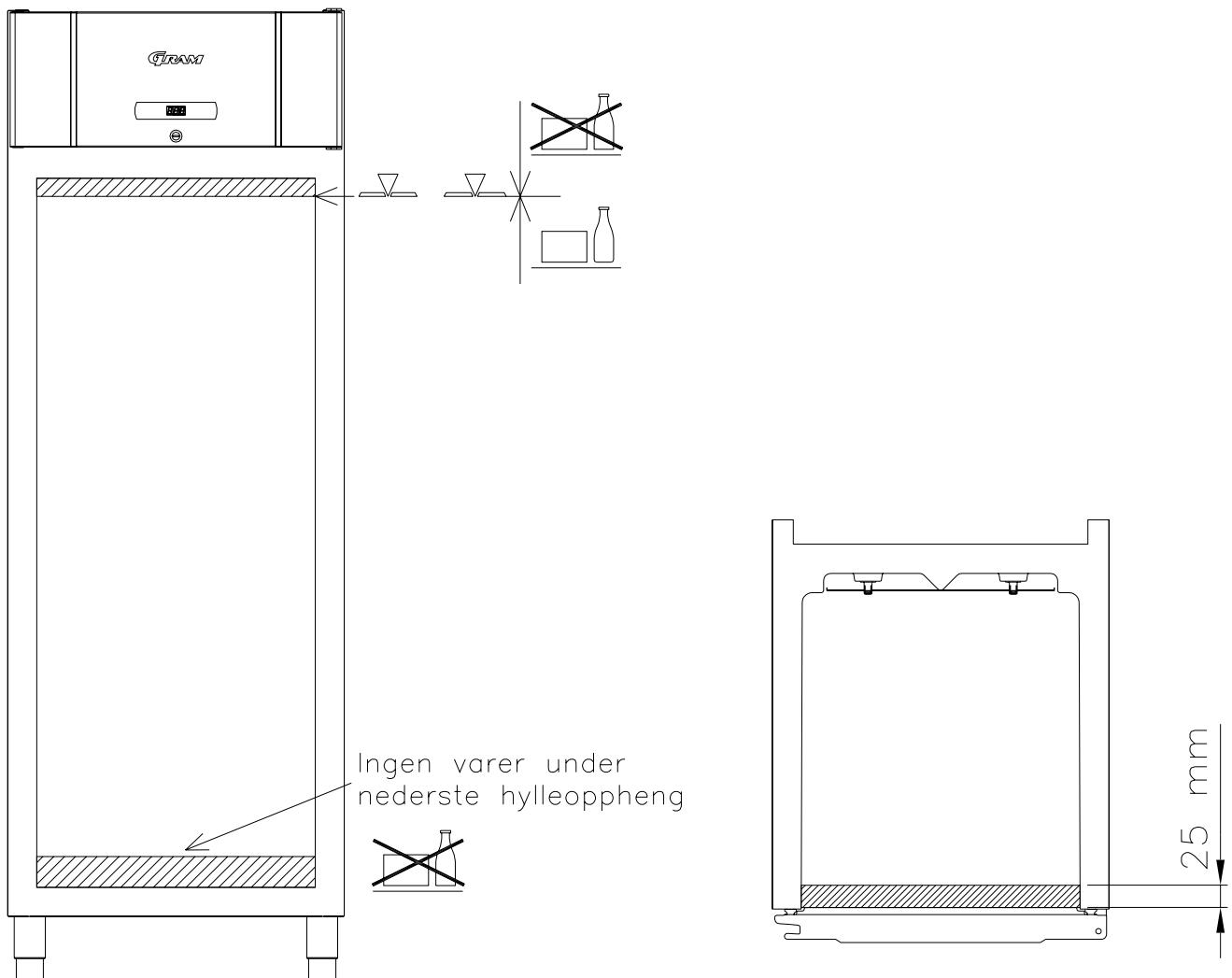
Alle matvarer som ikke allerede er emballert, og som skal lagres i skapet, må tildekkes for å hindre unødig korrosjon av skapets innvendige deler, herunder bl.a. fordamperen.
