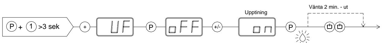
Skåpet kommer nu att hålla en temp. av  $+8^\circ\text{C}$ .
