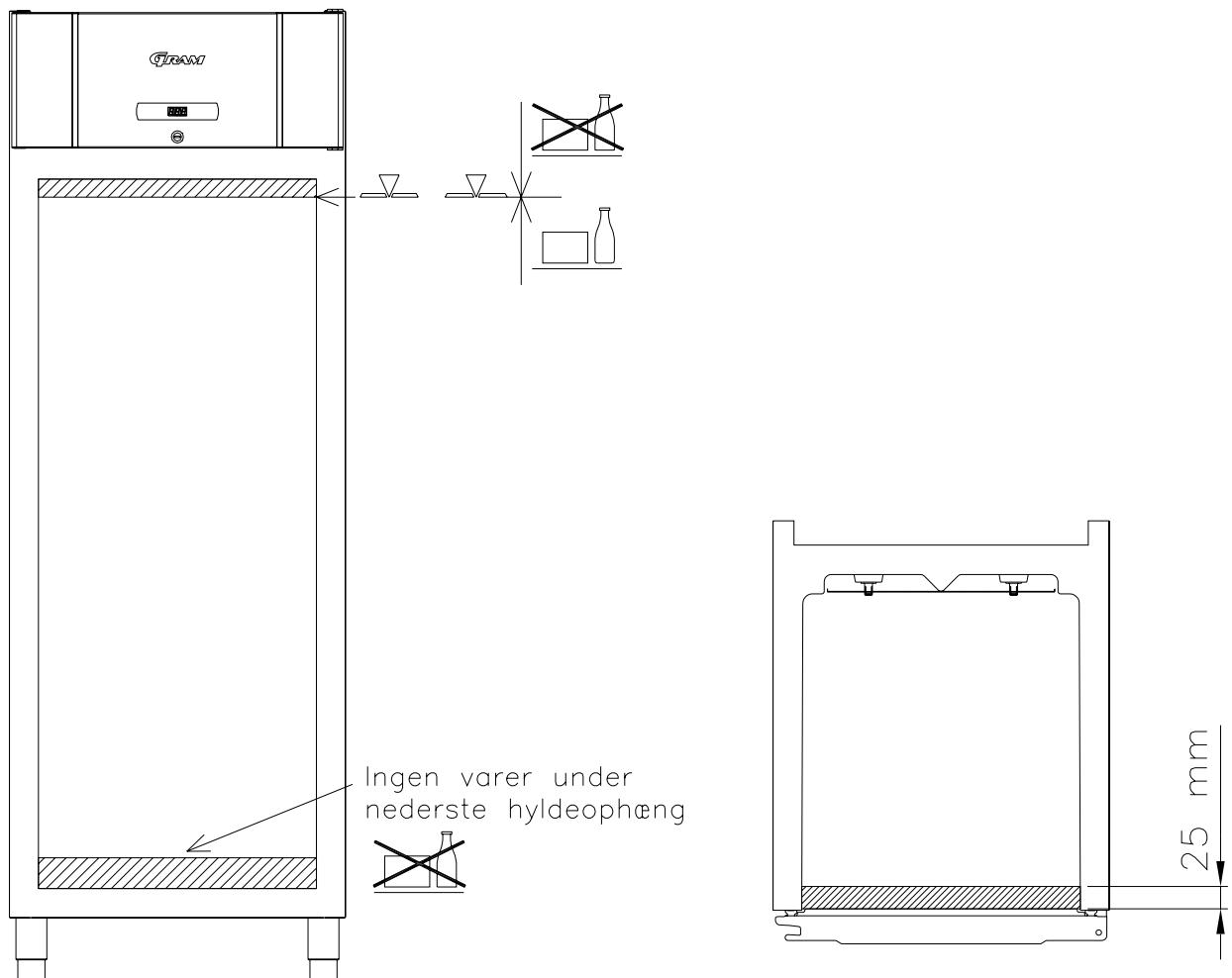
Alle varer, som ikke er emballeret i forvejen, og som skal opbevares i skabet, tildækkes for at forhindre unødig korrosion af skabets indre dele, herunder bl.a. fordamperen.
