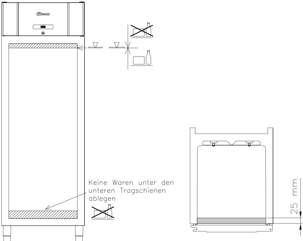
Alle unverpackten Lebensmittel, die im Schrank gelagert werden sollen, sind zu bedecken, um unnötige Korrosion des Schrankinnern, u.a. des Verdampfers, zu vermeiden.
